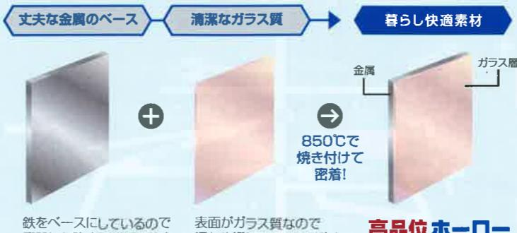
鉄をベースにしているので衝撃にも強さを発揮します。
